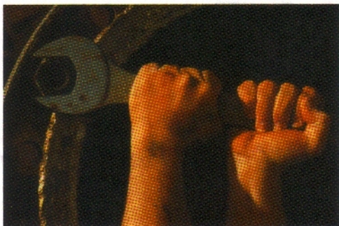
Fotografía 3.2 La fuerza ejercida por cada mano sobre la llave puede reemplazarse por un sistema equivalente fuerza-par que actúa sobre la tuerca.
